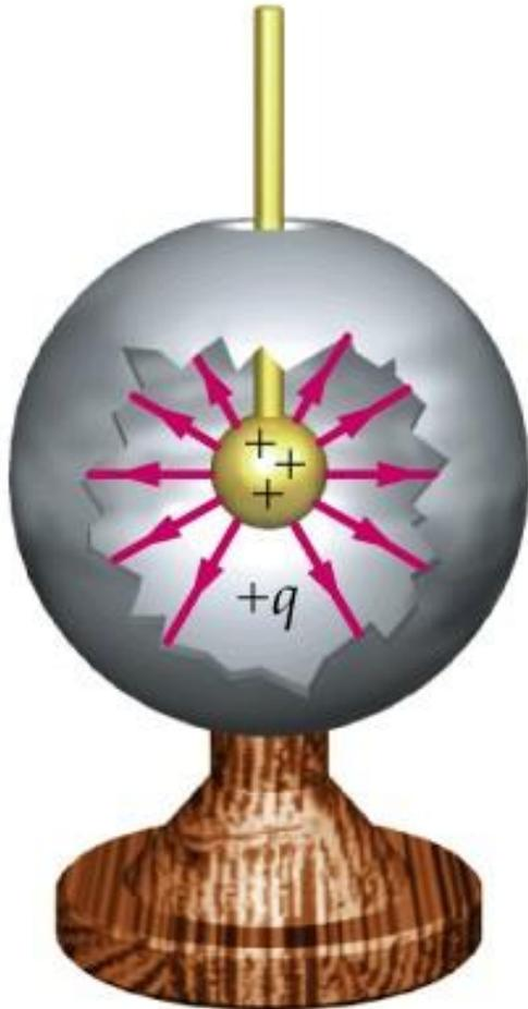
Un conductor pequeño con carga  $+q$  se encuentra en un hueco en el interior de un conductor.
