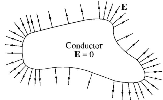
**Ruptura dieléctrica:** la cantidad de carga neta que puede contener un conductor esta limitada por el hecho que, en presencia de un campo eléctrico muy intenso, las moléculas del medio que rodea al conductor se ionizan y el medio se transforma en conductor. Para el aire  $E_{\max} = 3 \times 10^6$  V/m (**resistencia o rigidez dieléctrica** de un material = intensidad del campo eléctrico para la cual se produce la ruptura dieléctrica del material).
