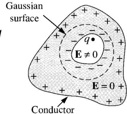
$$\oint \vec{E} \cdot d\vec{l} = 0 \quad \int_{\text{Linea punteada}} \vec{E} \cdot d\vec{l} + \int_{\text{Linea solida}} \vec{E} \cdot d\vec{l} = 0$$
